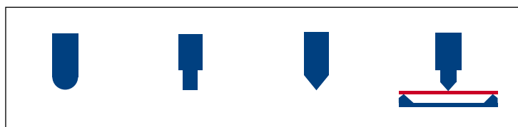
Meßsysteme mit unterschiedlichen Formen (rund, flach, spitz) und Biegelager können verwendet werden.
