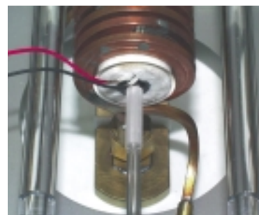
Erweiterung: Heizring für nichtelektrisch leitende Proben
