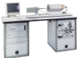
Dilatometer Typ 802 mit 2400°C Ofen
