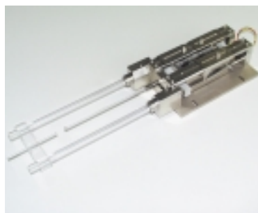
Erweiterung: Alpha-Meßsystem aus Quarz für hochgenaue Ausdehnungsmessungen
